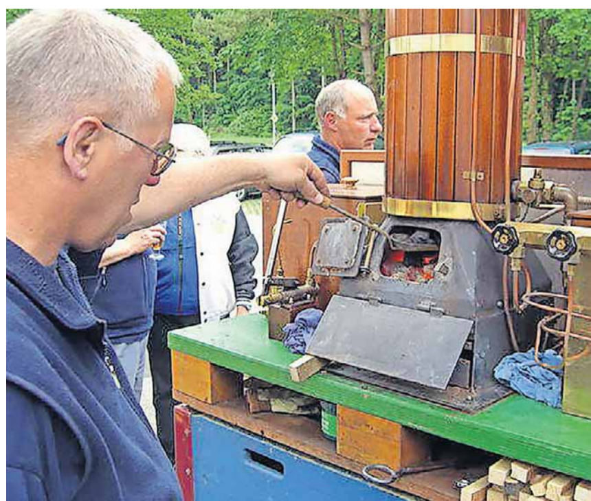
Die Dampfkaffeemaschine besteht aus einem Dampfkessel mit Kohlefeuerung. Die Kaffeeerhitzung erfolgt durch die Dampfschnecke.
